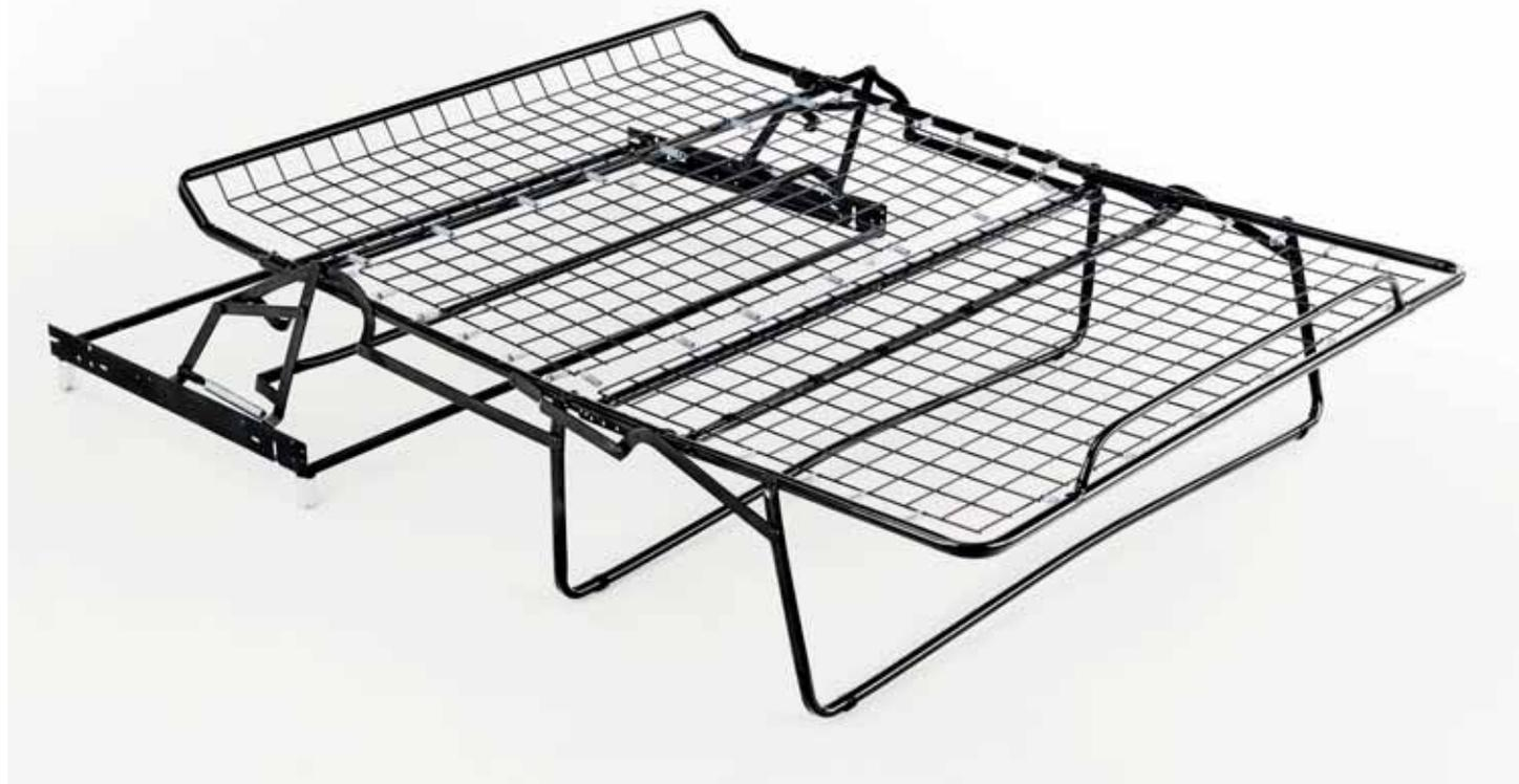
Meccanismo a due pieghe per divano letto con piano di coricamento a rete elettrosaldato e cinghie nella seduta. Il modello Luca Elettrosaldato può contenere un materasso alto 12 cm. e lungo 187 cm. La griglia elettrosaldato facilita la costruzione delle cuscinate di seduta del divano. La struttura in tubolare da 25 mm. e leveraggi ad alta resistenza garantiscono solidità e affidabilità.
